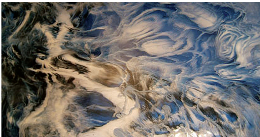
FIGURA 6 Il marmorino è stato per secoli il tipico intonaco veneziano ; per le elevate proprietà traspiranti assorbe dai muri l'umidità in risalita, restituendola rapidamente all'atmosfera.
